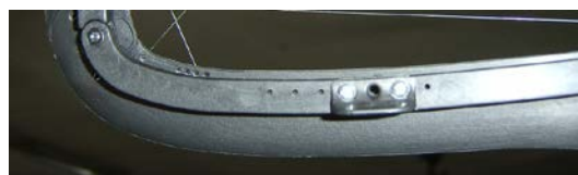
Bohrung im Mückenputzer
